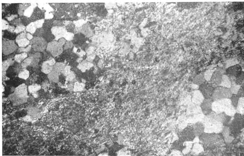
Obr. 1. Typické granulované porfyroblasty kremeňa v porfyroide. Zv. 120 \times .
