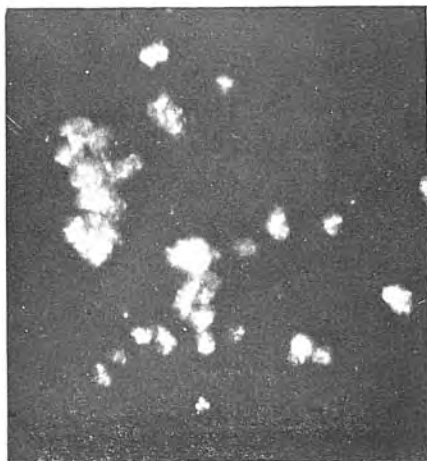
Obr. 2. Refikit z lignitu (Nováky). Polarizované svetlo, zv. 35 \times .
